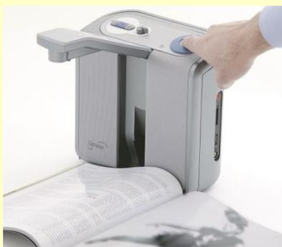
電源を入れてスキャンボタンを押すだけで、活字を撮影し、音声で読み上げる視覚障害者用読書器。約2.5kgと軽量で、折り畳み可能な取っ手付きなので、簡単に持ち運んで使用できる。バッテリー駆動なので、電源の無い場所でも使用できる。
