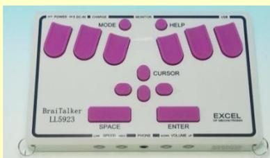
6点点字入力による小型端末。メモ帳、カレンダー、時計機能を搭載。点字ディスプレイは無く、入力した内容は音声で案内。
